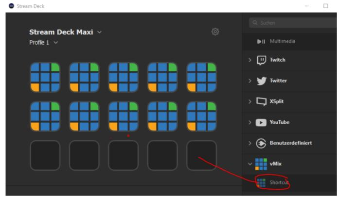
Danach kann in vMix mit FIND auch die Taste eines Streamdeck Controllers eingelesen werden. Streamdeck kennt 2 Funktionen pro Taste. Gedrückt, Losgelassen. Mit einem Elgatro Streamdeck kann so z.B. eine Gegensprech-Funktion realisiert werden, da das Streamdeck zwischen Tastegedrückt und Taste-losgelassen unterscheidet.
